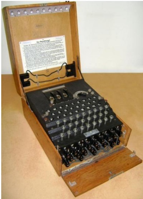
Figura 16. Imatge de màquina Enigma (Wehrmacht Enigma I) de https://www.ciphermachinesandcryptology.com/en/enigmatech.htm de l'autor D. Rijmenants.
