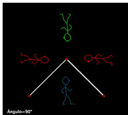
Solamente se obtiene una imagen nítida para ciertos ángulos: los divisores enteros de  $180^\circ$ , esto es,  $180^\circ, 90^\circ, 60^\circ, 45^\circ, 36^\circ, 30^\circ, \dots$  (¡compruébalo!).
