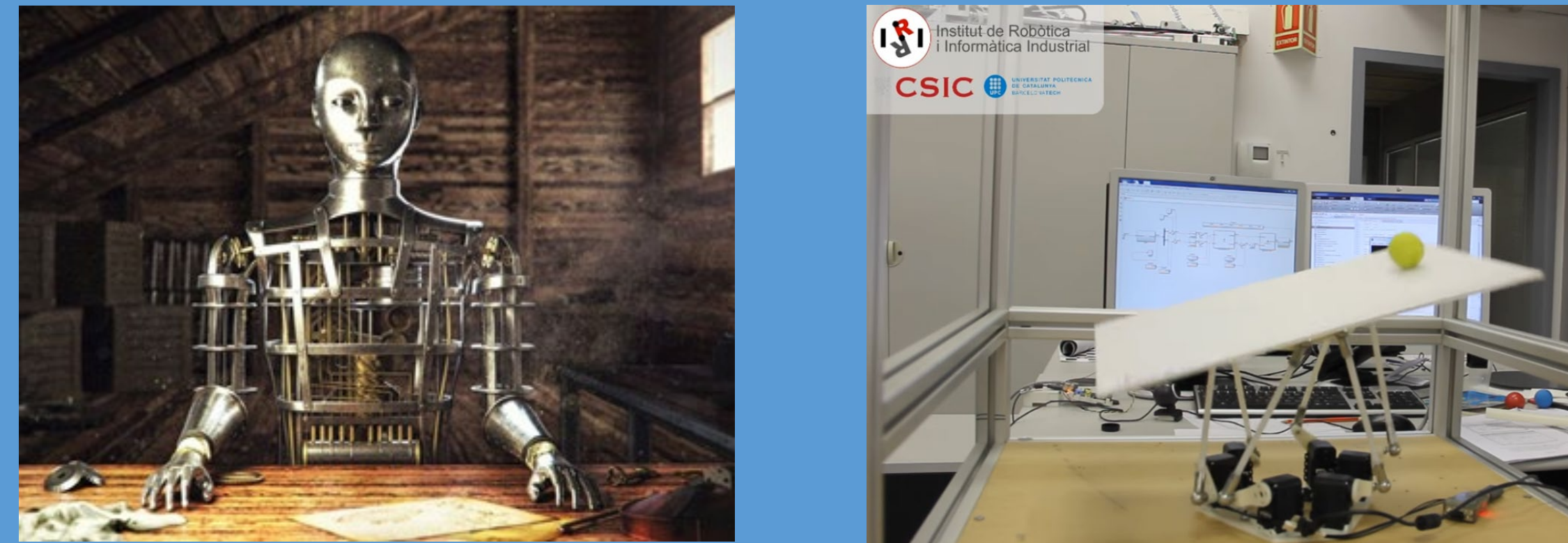
Robot experimental: plataforma de Stewart amb sistema de visió
