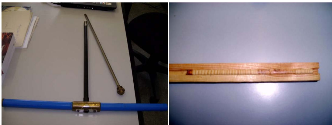
Figura 2: Barrena de Pressler (izquierda) y testigo de madera (derecha)
