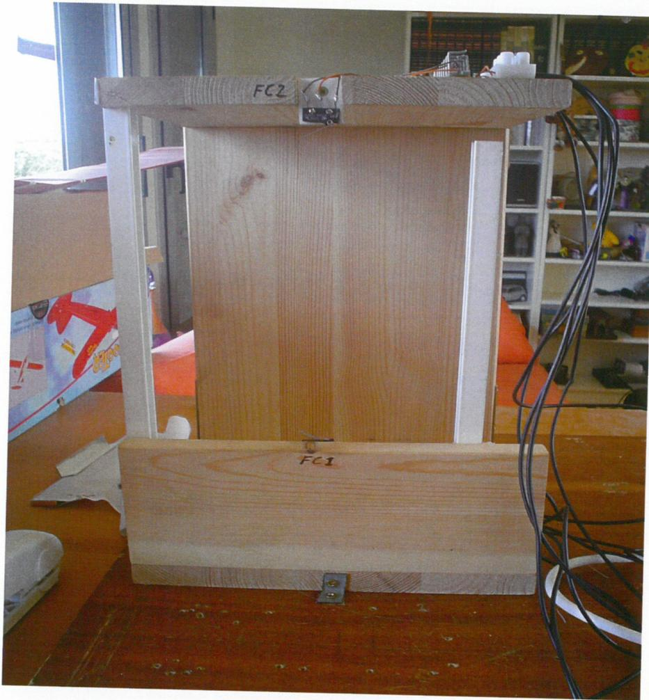
En esta imagen se puede ver la persiana físicamente, con los dos finales de carrera, uno arriba y el otro abajo, dos carriles para que baje la persiana, y el cableado que sale del motor de la persiana (arriba a la derecha de la imagen)
