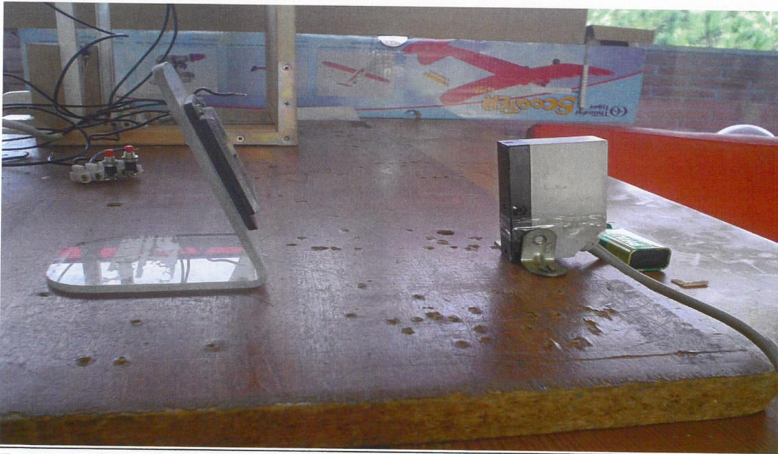
En esta imagen se puede ver la barrera fotovoltaica, que consta de dos instrumentos: un espejo y la propia barrera. La barrera necesita el espejo, para saber hasta donde llega el espacio donde puede pasar la puerta de garaje.
