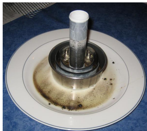
Figures 2.14: Experiment per estudiar la dispersió d'un líquid a través d'un filtre de sòl porós i recipients concèntrics per recollir el líquid
