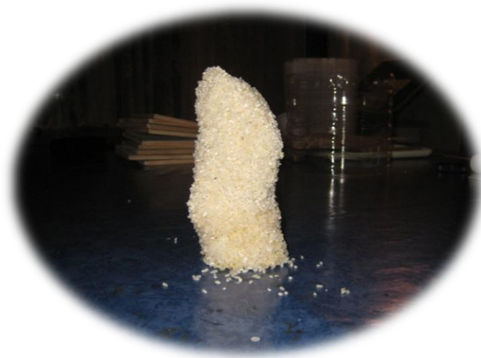
Figura 4.4: Grans d'arròs adherits pel pas del líquid
