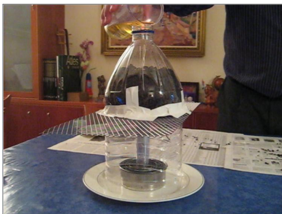
Figures 2.14: Experiment per estudiar la dispersió d'un líquid a través d'un filtre de sòl porós i recipients concèntrics per recollir el líquid
